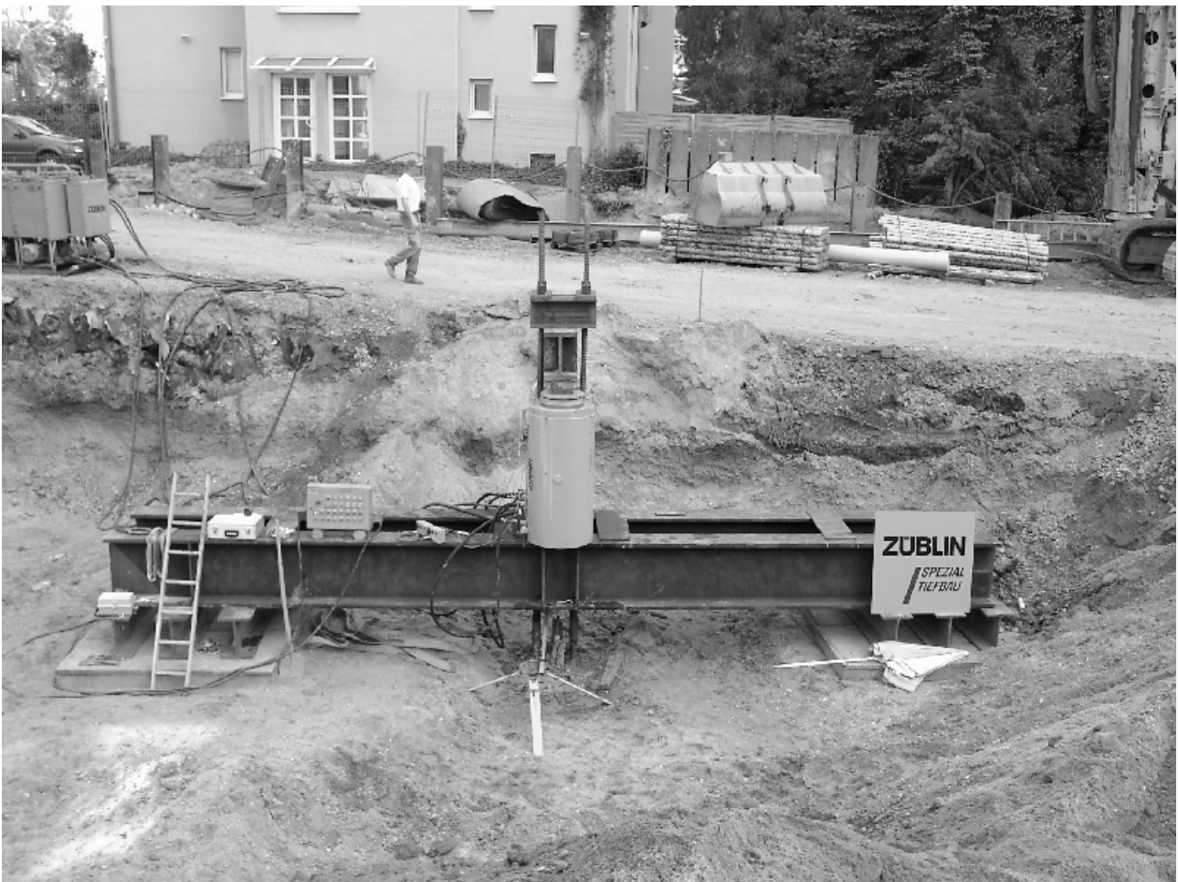
Bild 1: Versuchsaufbau in situ • Vergleichende Pfahlprobelastungen im Frankfurter Ton in der Hamburger Allee in Frankfurt am Main
