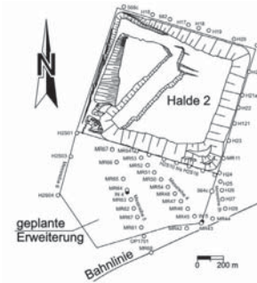
Bild 12: Lageplan des installierten Messprogramms
